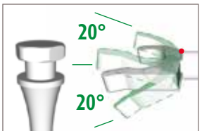
3 Anbiegen des C-Clips an Insektionswinkel
