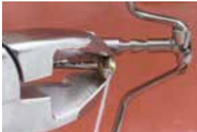
14 Aktivierung: Sicherungsfaden entfernen
