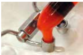
Kunststoff einpressen in Klebehülse
